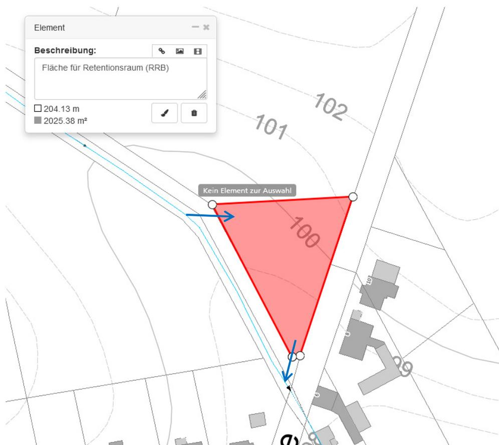
Abbildung 7: Angedachte Fläche für die Herstellung eines Regenrückhaltebecken/Schlammfang
