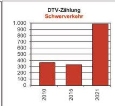
(20) Überlagert man alle Zählstellen, die auf den Planungsraum zuführen (außer Zählstelle 450 auf der überproportional belasteten B 244), so ergeben sich seit 2010 weitgehend konstante Verkehrsmengen im Kfz-Bereich, während der Schwerverkehr hingegen zunahm.
