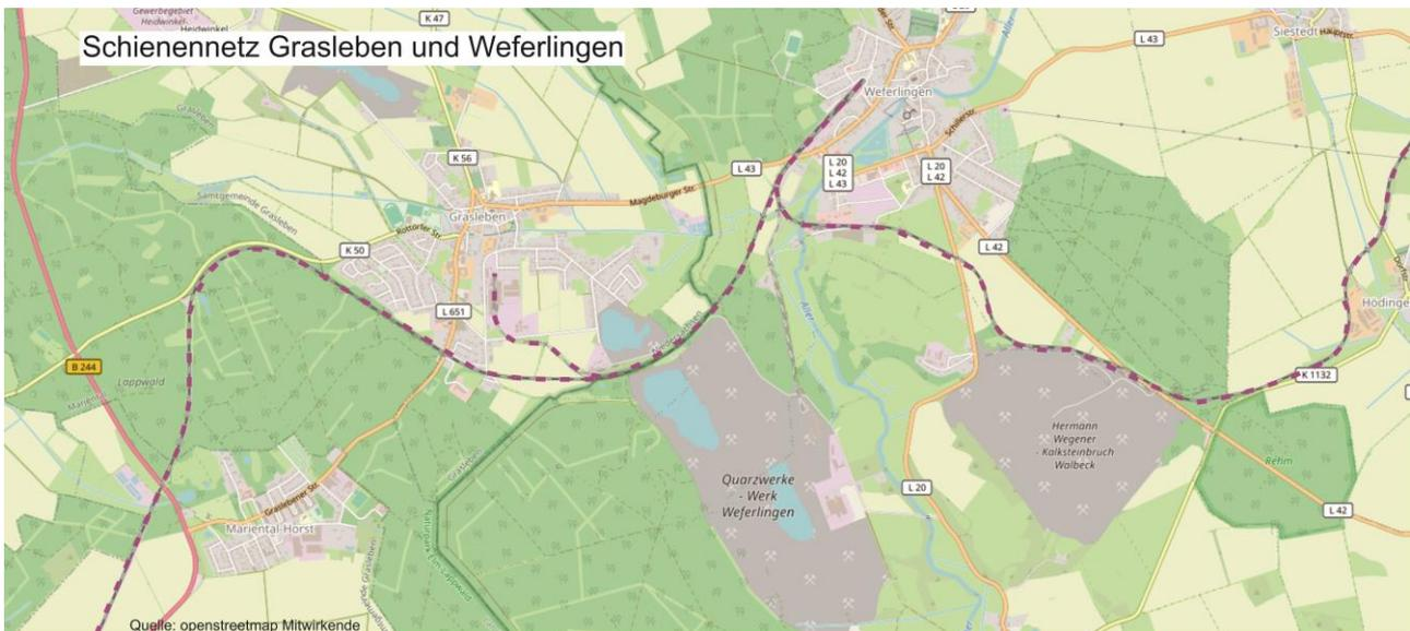
(22) Grasleben und Weferlingen sind über das Schienennetz mit Helmstedt im Westen und Haldensleben im Osten verbunden. In Grasleben wird die L 651 durch eine Bahnbrücke überquert. In Weferlingen sind im Zuge der L 43, L 20 und L 42 höhengleiche Bahnübergänge vorhanden. Aufgrund der nur geringen Zugfrequenzen ergeben sich dadurch aber keine erheblichen negativen Auswirkungen für den straßengebundenen privaten Kfz-, Buslinien-, Rad- oder Fußverkehr.
